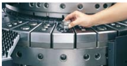
Schneller, einfacher Werkzeugwechsel im Z-Revolver mittels Auswerferhülse
