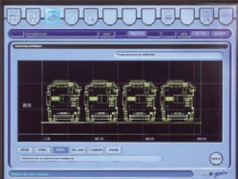
Gereedschapswisselpositie met grote gereedschapsrevolver met 51 stations
