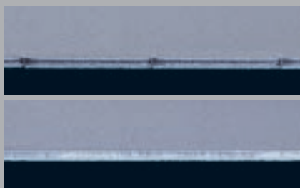
Foto boven zonder, onder met slotting tool
